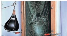
安全合わせ複層ガラス (UVカット機能付) 破壊試験状況 (ショットバッグ試験) 画像提供:AGC株式会社
